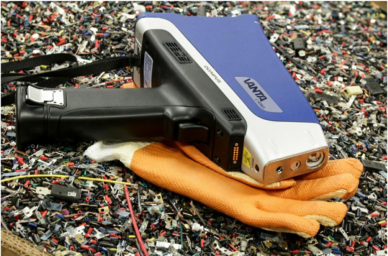
Figura 3. Analizador XRF portátil Vanta
